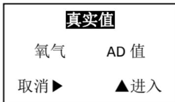
5) 打开氮气浓度值为 99.999% 的标准气瓶，进行通气，待数值稳定后按“确定”键确认保存（若进入的是标定点二或标定点三子菜单，则用客户现有标准气瓶进行通气）
